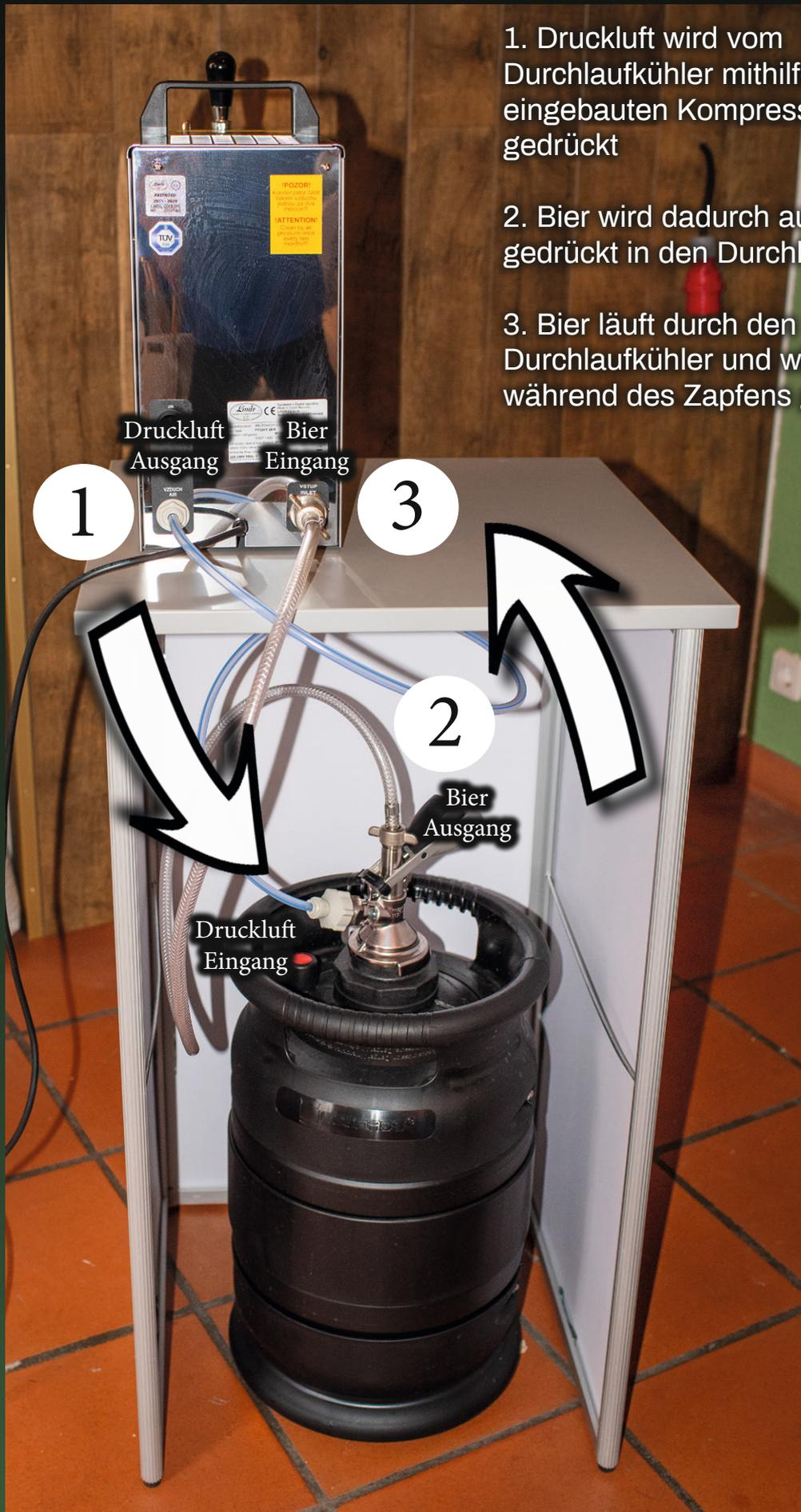
1. Druckluft wird vom Durchlaufkühler mithilfe des eingebauten Kompressors ins Keg gedrückt
