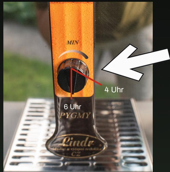
Drehe den Hebel für die Zapfgeschwindigkeit wieder ganz nach oben, also zu - kein Durchfluss.
